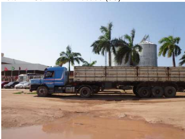
Foto 3 – Caminhão Trator + Semi Reboque (2S3).
